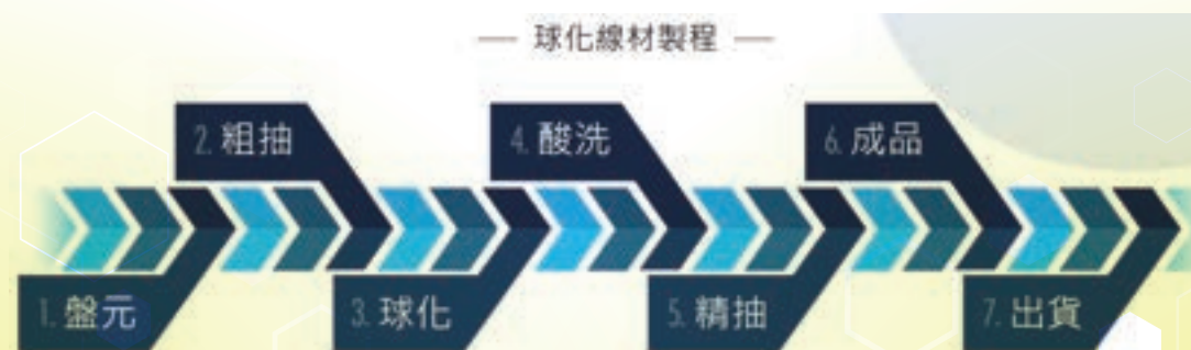
圖3-8聚亨企業球化線材製程
