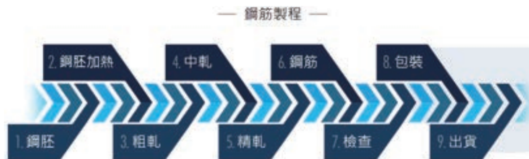
圖3-7 聚亨企業鋼筋製程
