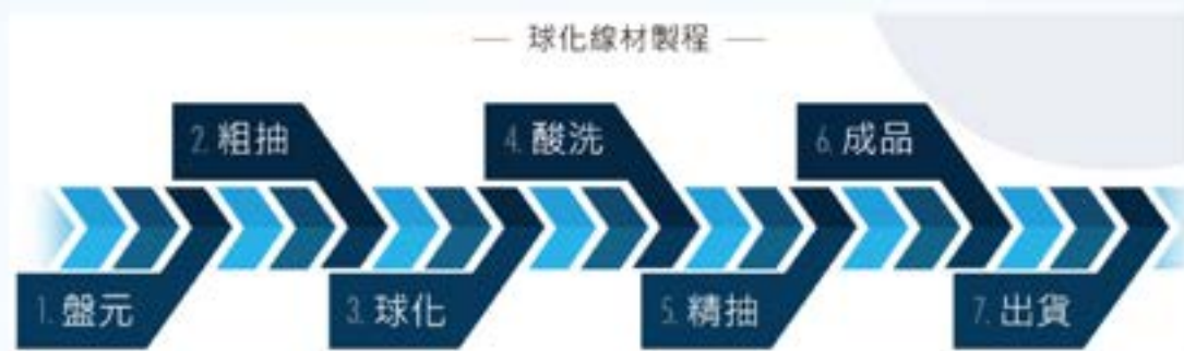
圖3-9球化線材製程
